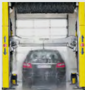
Система мойки высоким давлением со всех сторон
